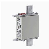
**Cartouche fusible, grande vitesse, 10 A, AC 690 V, 200 kA, DIN 000, gR, DIN, IEC, indicateur de type T, pattes d'extraction conductrices**
