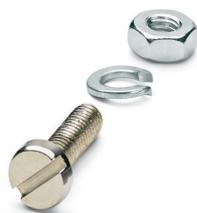
Jeu de vis, pour fixer l'embase sur la paroi de l'appareil, se compose de respectivement 1 vis M3 x 10, 1 rondelle Grower et 1 écrou
