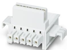
Connecteurs sur profilé, coloris: gris, intensité nominale: 8 A (contacts parallèles), tension de référence (III/2): 125 V, nombre de pôles: 5, pas: 3,81 mm, montage: Montage sur profilé, verrouillage: sans, type de fixation: sans, type de conditionnement: emballé dans un carton, Article avec contacts dorés, connecteur de bus pour le raccordement de boîtiers électroniques, 5 contacts parallèles
