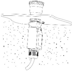
Bloc de contact protégé pour les dispositifs de commande utilisés dans les tableaux électriques avec présence de poussière, même à l'intérieur du tableau. Le bloc assure un degré de protection IP67 aux contacts électriques internes.
