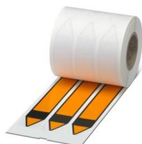
Repère pour conduite, Rouleau, jaune/noir, préimprimé, repérable avec : THERMOMARK E.300 (D)/600 (D), THERMOMARK ROLL 2.0, THERMOMARK ROLL, THERMOMARK ROLL X1, THERMOMARK ROLLMASTER 300/600, THERMOMARK X1.2, type de montage: collage, diamètre: 0 mm, surface utile: 26 x 280 mm, Nombre d'étiquettes: 250
