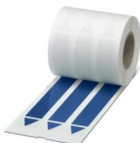
Repère pour conduite, Rouleau, bleu, préimprimé, repérable avec : THERMOMARK E.300 (D)/600 (D), THERMOMARK ROLL 2.0, THERMOMARK ROLL, THERMOMARK ROLL X1, THERMOMARK ROLLMASTER 300/600, THERMOMARK X1.2, type de montage: collage, diamètre: 0 mm, surface utile: 26 x 280 mm, Nombre d'étiquettes: 250
