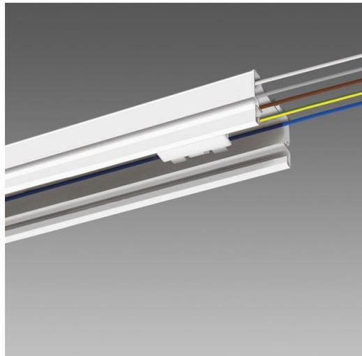
Structure porteuse pour la composition de lignes continues avec luminaires Techno System ou mixtes. Installation simple et rapide sur mur, en plafonnier ou en suspension grâce à la grande variété des accessoires. Le canal comporte, de série, une alimentation à 5 pôles, à 7 pôles (pour les versions secours et gradables DALI) et à 11 pôles, avec borniers à raccord rapide.
