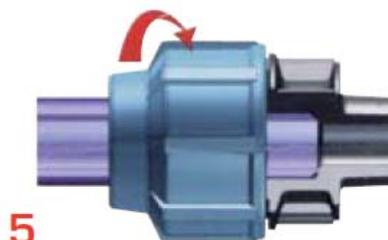
5. Visser l'écrou d'accouplement en le serrant à fond. Serrage manuel ou mécanique (par exemple avec clé à tube) jusqu'au diamètre D 32. Serrage mécanique (avec clé de montage) à partir du diamètre D 40.
