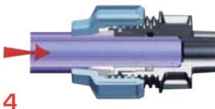
4. Continuer de pousser le tube jusqu'à la seconde butée : le montage est correct (contrôler la marque sur le tube).
