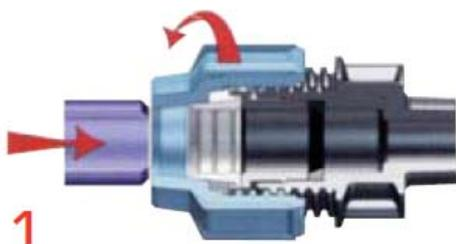
1. Couper le tube droit et éliminer soigneusement les bavures. Graisser le joint s'il est sec. Desserrer l'écrou.
