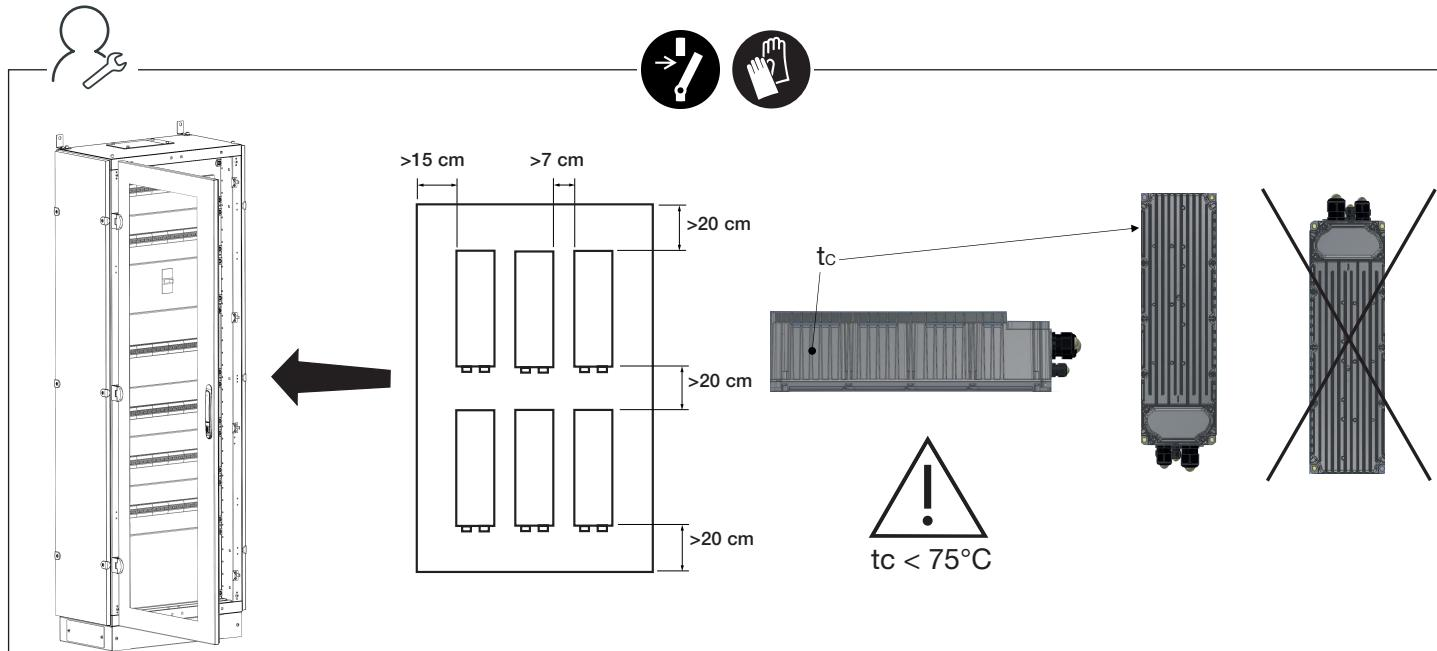
IT Se necessario, utilizzare un ventilatore o un dispositivo di climatizzazione dell'aria per ridurre il surriscaldamento interno. -
