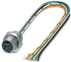
Connecteur d'appareil face arrière, Ethernet CAT5 (CEI 11801:2002) (100 Mbit/s), 8-pôles, connecteur femelle, droit, M12-SPEEDCONNEC, détrompage: Y, sur extrémité libre, Montage face arrière, M16 x 1,5, Cordons individuels, longueur de câble: 0,5 m, 0,14 mm<sup>2</sup>, Cordon TPE, Produit de remplacement selon RoHS II sans exception 6c (Pb < 0,1 %) référence : 1238753
