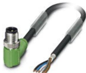
Câbles pour capteurs/actionneurs, 5-pôles, PUR exempt d'halogène, gris-noir RAL 7021, blindé, Connecteur coudé M12, détrompage A, sur extrémité libre, Longueur du câble: 5 m
