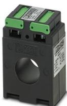
Transformateur de courant à canon, courant primaire 50 A AC, courant secondaire 5 A AC ; classe de précision 1 ; puissance assignée 1,25 VA
