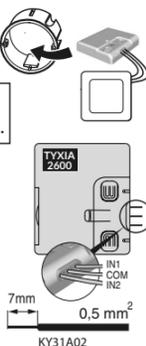
Possibilité de rallonger jusqu'à 10m les fils de la commande locale (à séparer du 230V).
