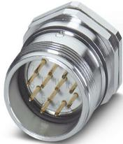
M23, Embases paroi avant, série: RC, droit, blindé: oui, Verrouillage à vis, Nombre de pôles: 6+3, Sens de rotation: standard, type de contact: Mâle, Cône de soudage, Joint torique axial, Fixation centrale, Epaisseur de paroi min.: 1 mm, Epaisseur de paroi max.: 4,5 mm, détrompage: N, Produit de remplacement selon RoHS II sans exception 6c (Pb < 0,1 %) référence : 1242691
