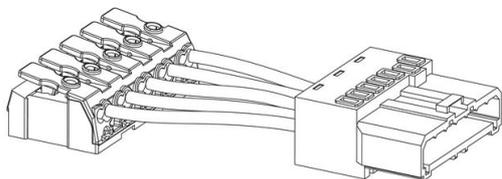
in policarbonato. Da utilizzare sempre per l'alimentazione del canale. Conduttori di sezione ammessa 2.5 mm<sup>2</sup>.
