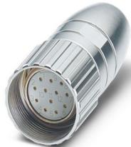
M23, Connecteurs à câble, droit, blindé: non, Verrouillage à vis, Nombre de pôles: 6, Sens de rotation: standard, type de contact: Connecteur femelle, Raccordement à sertir, plage de diamètre de câble: 3 mm ... 10,5 mm, détrompage: N, L'article est sans plomb, conformément à la directive RoHS II, sans exception 6c (Pb < 0,1 %)
