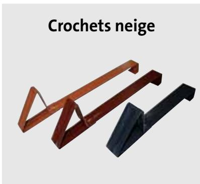
Le **crochet neige** bloque la neige sur le toit afin d'éviter les chutes d'amas de neige. Le crochet en aluminium laqué vient se bloquer entre deux tuiles ou deux ardoises.
