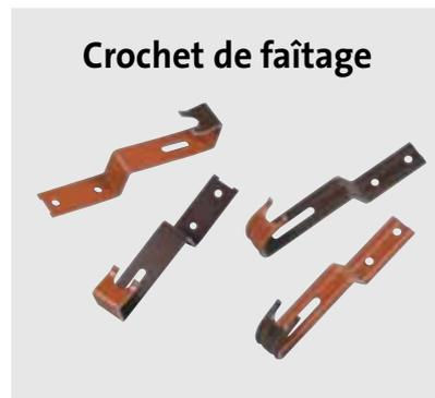
Le **crochet de faitage** se cloue sur la lisse de réhausse ou d'arêtier et vient bloquer la tuile faîtière. Les crochets de faitage sont conçus en aluminium et en zinc.
