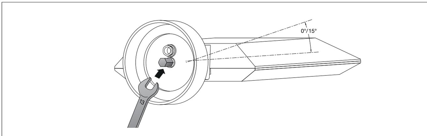
Auf richtigen Sitz der Dichtung achten. Leuchte wie in Skizze dargestellt auf die Montageplatte setzen, ausrichten und fest verschrauben.
