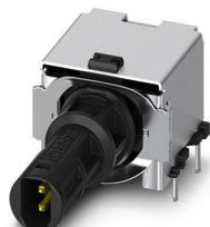
Connecteurs pour circuits imprimés du dispositif de protection sensible, type: IEC 63171-5, indice de protection: IP65/IP67, nombre de pôles: 2, CAT B (ISO/IEC 63171), matériau: Métal, type de raccordement: Raccordement soudé THR, Single Pair Ethernet
