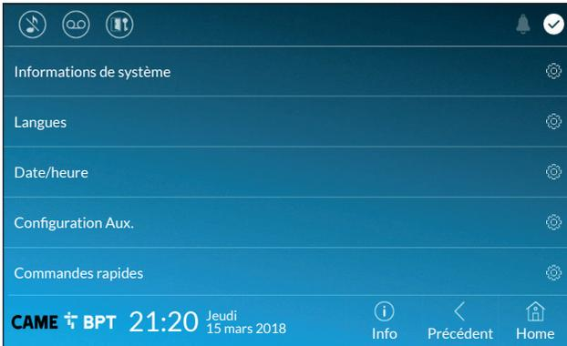
La fenêtre contient une série d'informations techniques utiles à l'identification des caractéristiques du dispositif, la version ordinateur et logiciel.
