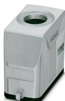
Capot passe-câble D15, pour étrier longitudinal, matériau: Aluminium coulé sous pression, résistant à l'eau de mer, nombre de sorties: 1, droit, 1x Pg13,5, hauteur: 56 mm, presse-étoupe: sans, Standard
