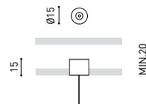
Wire Trimless Accessory est une collection d'accessoires qui permettent d'installer les tendeurs et les câbles des luminaires suspendus d'Arkoslight directement au plafond, sans rosette ni fixation apparente. Ceci permet d'obtenir une application minimaliste et visuellement propre dans l'espace.
