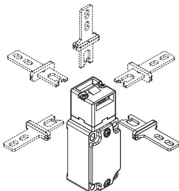
En enlevant les deux vis de fixation, il est possible de tourner la tête de tous les interrupteurs par pas de 90°. De cette manière, il est possible d'actionner l'interrupteur depuis 5 directions différentes.
