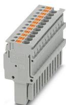
Connecteurs, tension nominale: 500 V, intensité nominale: 17,5 A, nombre de connexions: 12, nombre de pôles: 12, type de raccordement: Raccordement Push-in, 1er étage, Section de référence: 1,5 mm<sup>2</sup>, section : 0,14 mm<sup>2</sup> - 1,5 mm<sup>2</sup>, coloris: gris
