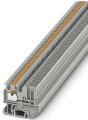
Bloc de jonction miniature, tension nominale: 500 V, intensité nominale: 17,5 A, nombre de connexions: 2, type de raccordement: Raccordement Push-in, 1er étage, Section de référence: 1,5 mm<sup>2</sup>, section : 0,14 mm<sup>2</sup> - 1,5 mm<sup>2</sup>, type de montage: NS 15, coloris: gris
