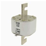
**Cartouche fusible, Basse tension, 630 A, AC 690 V, 120 kA, NH4, gL/gG, IEC, indicateur de fusion simple, pattes d'extraction conductrices**
