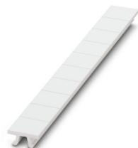
Ruban de repérage ZB, à commander : par bandes, blanc, impression selon les indications du client, type de montage: encliquetage dans la rainure de repérage élevée, pour bloc de jonction au pas de : 10,2 mm, surface utile: 10,15 x 10,5 mm, Nombre d'étiquettes: 10
