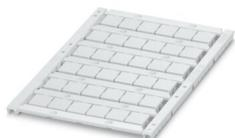
Repères pour blocs de jonction, à commander : sous forme de planche, blanc, impression selon les indications du client, type de montage: encliquetage dans la rainure de repérage élevée, pour bloc de jonction au pas de : 10,2 mm, surface utile: 8,9 x 9,6 mm, Nombre d'étiquettes: 36
