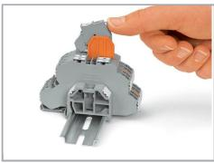
Une plaque d'extrémité pour borne à fusible (ici orange, 2002-1092) sert de protection supplémentaire contre l'ouverture du portefusible. Le remplacement de fusible ne peut se faire que lorsque le porte-fusible a été déconnecté du circuit.
