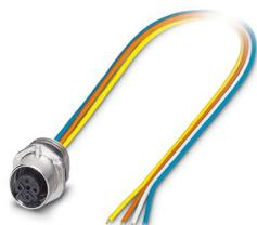
Embases paroi avant, PROFINET CAT5 (CEI 11801:2002), 4-pôles, connecteur femelle, droit, M12-SPEEDCONNEC, détrompage: D, sur extrémité libre, Montage sur face avant, M16 x 1,5, Cordons individuels, Cordon TPE
