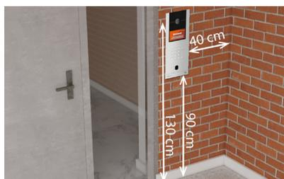
Pour être conforme avec la loi accessibilité, les systèmes de contrôle d'accès et de communication doivent être situés à une hauteur comprise entre 0,90 m et 1,30 m. Ils devront être également situés à plus de 0,40 m d'un angle rentrant de parois ou de tout autre obstacle à l'approche d'un fauteuil roulant.
