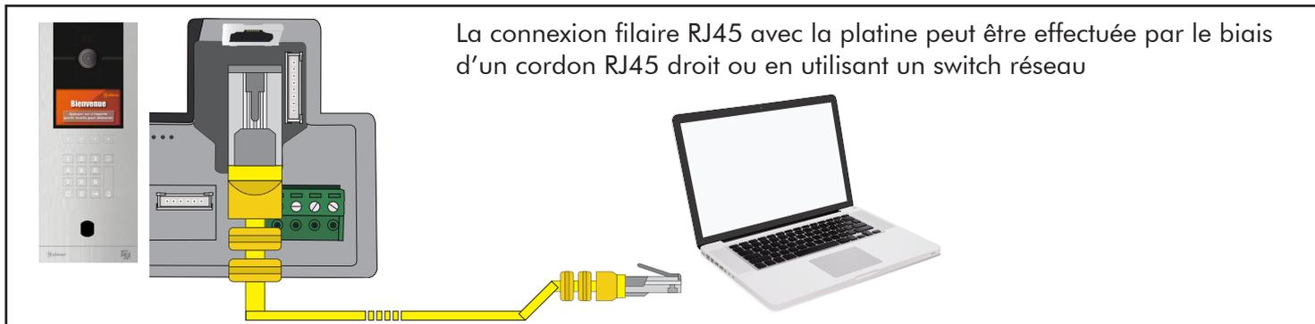
La connexion filaire RJ45 avec la platine peut être effectuée par le biais d'un cordon RJ45 droit ou en utilisant un switch réseau
