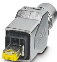
Connecteur RJ45, indice de protection: IP65/IP67, nombre de pôles: 8, 10 Gbit/s, CAT6<sub>A</sub>, type de raccordement: Raccordement autodénudant IDC, section raccordable: AWG 23- 22, sortie du câble: droit, Ethernet
