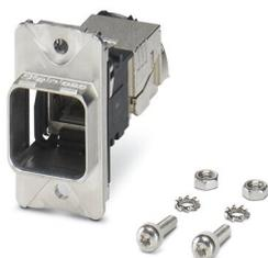
Cadre de montage RJ45, IP67, pour verrouillage Push-Pull, métallique, pour découpe de montage rectangulaire, avec joint, vis de fixation et embout RJ45 avec raccordement de câble IDC
