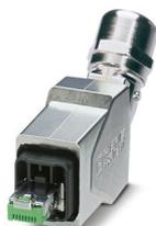
Connecteur RJ45, indice de protection: IP65/IP67, nombre de pôles: 8, 1 Gbit/s, CAT5, matériau: Métal, type de raccordement: Raccordement autodénudant IDC, section raccordable: AWG 23- 22, sortie du câble: coudé, Ethernet
