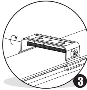
Insérez le boulon de tension et fixez le luminaire aux clips métalliques.
