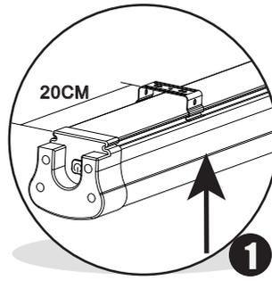
Fixez les deux clips métalliques en position et fixez-les à la surface. Il est recommandé de positionner chaque clip à environ 20 cm de chaque extrémité du luminaire.
