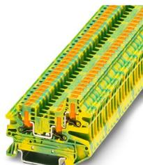
Bloc de jonction pour conducteur de protection, nombre de connexions: 3, type de raccordement: Raccordement Push-in, section : 0,14 mm<sup>2</sup> - 4 mm<sup>2</sup>, type de montage: NS 35/7,5, NS 35/15, coloris: vert/jaune
