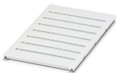
Repères pour blocs de jonction, Plaque, blanc, vierge, repérable avec : BLUEMARK ID COLOR, BLUEMARK ID, BLUEMARK CLED, PLOTMARK, CMS-P1-PLOTTER, type de montage: encliquetage, pour bloc de jonction au pas de : 5,2 mm, surface utile: 4,6 x 10,5 mm, Nombre d'étiquettes: 96
