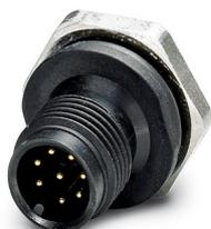
Connecteurs encastrables pour capteurs et actionneurs, connecteur mâle, 8 pôles, M12, détrompage A, montage vissé/sur face avant avec filetage M16, avec cônes de soudage, exécution plastique
