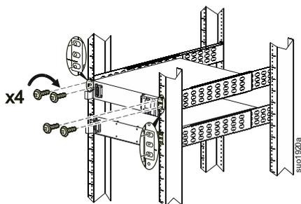
4 Installez le panneau avant pour le bloc-batterie ainsi que pour l'onduleur.
