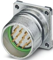
M23, Embases paroi avant, série: RC, droit, blindé: oui, Verrouillage à vis, Nombre de pôles: 17, Sens de rotation: inversé, type de contact: Mâle, Cône de soudage, Joint plat, 4x Ø2,7, cote de bride: 25 mm x 25 mm, détrompage: N, Produit de remplacement selon RoHS II sans exception 6c (Pb < 0,1 %) référence : 1242988
