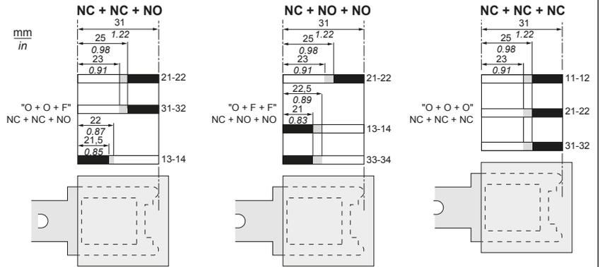
Head orientation / Orientation de la tête / Ausrichtung des Kopfteils / Orientación de la cabeza / Orientamento della testa / Orientação da cabeça
