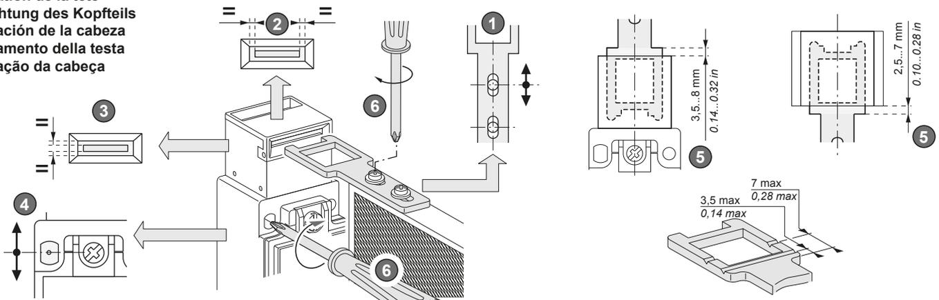
Position of keylock on XCS B/C / Orientation serrure à clé sur XCS B/C / Ausrichtung des Schlosses auf dem XCS B/C / Orientación cerradura de llave en XCS B/C / Orientamento serratura a chiave su XCS B/C / Orientação fechadura a chave em XCS B/C
