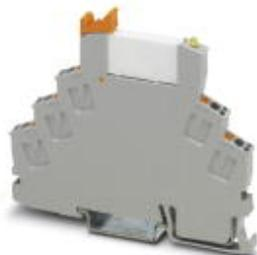
Module à relais prééquipé avec raccordement Push-in, comprenant : embase de relais avec éjecteur et relais à contacts de puissance. Type de contact : 1 contact inverseur. Tension d'entrée : 24 V DC
