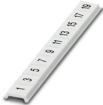
Ruban de repérage ZB, plat, Rubans, blanc, repéré, impression longitudinale: numérotation impaire 1-19, 21-39, etc. jusqu'à 81-99, type de montage: encliquetage, pour bloc de jonction au pas de : 5 mm, surface utile: 5,15 x 5,15 mm, Nombre d'étiquettes: 10
