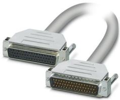
Câble rond prééquipé, blindé, exempt d'halogène; raccordement 1 : Connecteur femelle D-SUB (1x 50-pôles); raccordement 2 : Connecteur mâle D-SUB (1x 50-pôles); longueur de câble: 3 m
