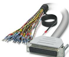
Câble rond blindé préconfectionné; raccordement 1 : Fils individuels (50-pôles) (Les fils sont repérés et équipés d'embouts. La tresse de blindage sort d'une extrémité de câble distincte.); raccordement 2 : Connecteur femelle D-SUB (1x 50-pôles); longueur de câble: 3 m
