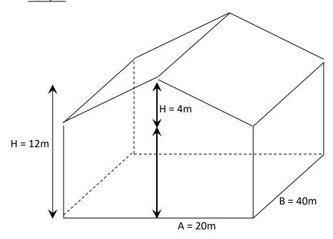
Le déstratificateur est installé à **8m**, la hauteur au-dessus du déstratificateur est 4m.
