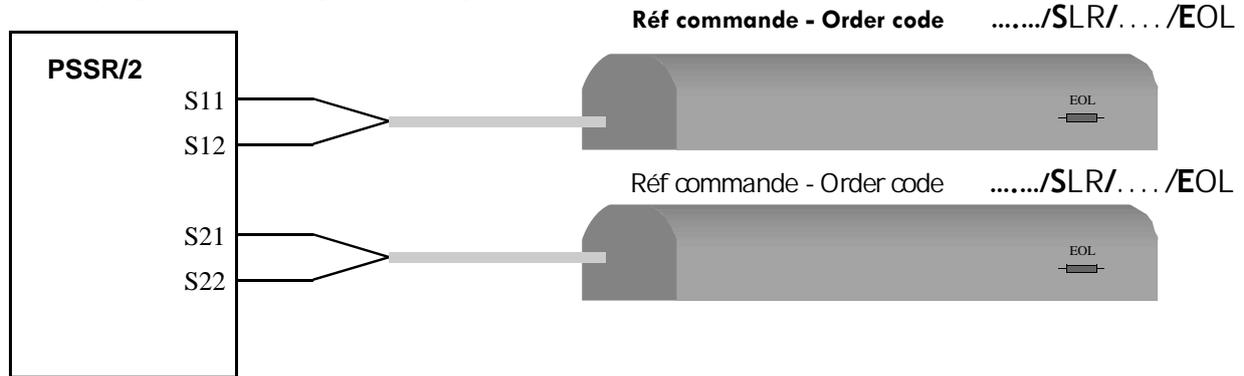
Plus de 2 bordures, configuration 2 fils et 4 fils, résistance intégrée dans chaque bordure 6.8 kilos ohms en fin de ligne
