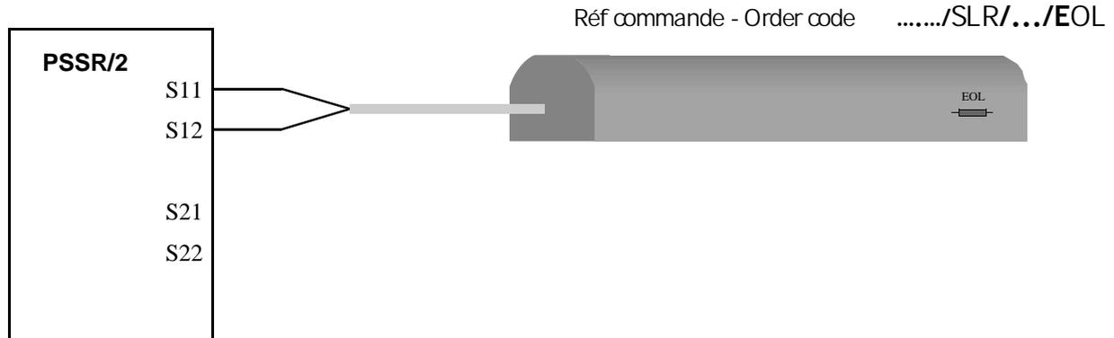
2 bordures, 2 fils en sorties, résistance intégrée 6.8 kilos ohms
