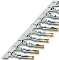
Contact à sertir, Connecteur femelle, roulés, Produits en bande, nombre de pièces par bande: 500, diamètre de contact: 1 mm, zone de sertissage: 0,08 mm<sup>2</sup> ... 0,22 mm<sup>2</sup>
