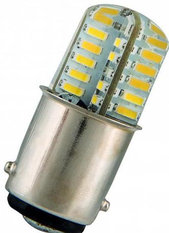
**LED Spéciale Ba15d T15X36 24V AC/DC 1.8W (15W) 140lm 841**
