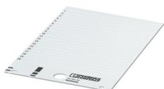
Repères pour blocs de jonction, Carte, blanc, vierge, repérable avec : BLUEMARK ID COLOR, BLUEMARK ID, THERMOMARK PRIME, THERMOMARK CARD 2.0, THERMOMARK CARD, type de montage: encliquetage, encliquetage dans la rainure de repérage plate, surface utile: 104 x 6,6 mm, Nombre d'étiquettes: 20
