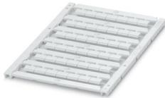
Repères pour blocs de jonction, Planche, blanc, vierge, repérable avec : TOPMARK NEO, LASER TOPMARK, BLUEMARK ID COLOR, BLUEMARK ID, BLUEMARK CLED, THERMOMARK PRIME, THERMOMARK CARD 2.0, THERMOMARK CARD, type de montage: encliquetage, pour bloc de jonction au pas de : 8,2 mm, surface utile: 7,4 x 4,7 mm, Nombre d'étiquettes: 42
