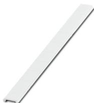
Ruban de repérage ZB, plat, à commander : par bandes, blanc, impression selon les indications du client, type de montage: encliquetage dans la rainure de repérage plate, pour bloc de jonction au pas de : 8 mm, surface utile: 5,15 x 8,15 mm, Nombre d'étiquettes: 10
