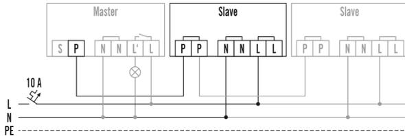
*Raccordement maître/esclave. Un appareil maître peut être raccordé à 10 appareils esclaves au maximum.*
