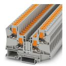
Blocs de jonction simple, tension nominale: 1000 V, intensité nominale: 41 A, nombre de connexions: 4, nombre de pôles: 1, type de raccordement: Raccordement Push-in, Section de référence: 6 mm², section : 0,5 mm² - 10 mm², type de montage: NS 35/7,5, NS 35/15, coloris: gris
