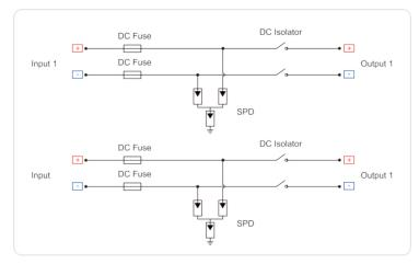
Remarque: il est possible de personnaliser les chaînes d'entrée et de sortie et de sélectionner une capacité de courant et de tension supérieure dans chaque chaîne.
