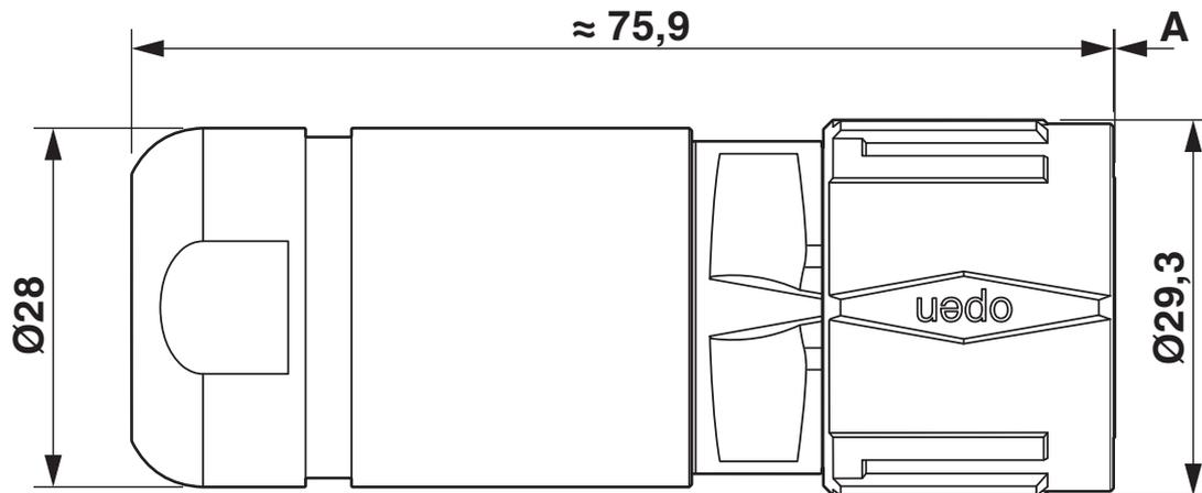
Type de connecteur mâle : dimension A = 0,2 mm, type de connecteur femelle : dimension A = 0 mm
