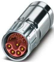
M23, Connecteurs à câble, série: SH, droit, long, blindé: oui, SPEEDCONNEC, Nombre de pôles: 8+4+PE, type de contact: Mâle, Raccordement à sertir, plage de diamètre de câble: 7,5 mm ... 18 mm, détrompage: N, Produit de remplacement selon RoHS II sans exception 6c (Pb < 0,1 %) référence : 1244430
