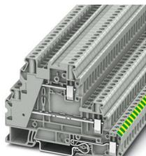
Bloc de jonction pour conducteur de protection, tension nominale: 500 V, intensité nominale: 30 A, nombre de connexions: 5, type de raccordement: Raccordement vissé, Section de référence: 4 mm<sup>2</sup>, section : 0,14 mm<sup>2</sup> - 6 mm<sup>2</sup>, Raccordement vissé, Section de référence: 4 mm<sup>2</sup>, section : 0,14 mm<sup>2</sup> - 6 mm<sup>2</sup>, type de montage: NS 35/7,5, NS 35/15, coloris: gris
