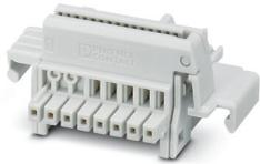
Connecteurs sur profilé, coloris: gris clair, intensité nominale: 6 A, 4 A (contacts parallèles) (Contacts série), tension de référence (III/2): 32 V, nombre de pôles: 8, pas: 2,54 mm, montage: Montage sur profilé, verrouillage: sans, type de fixation: sans, type de conditionnement: emballé dans un carton, Article avec contacts dorés, connecteur de bus pour le raccordement de boîtiers électroniques, 7 contacts parallèles/1 contact série
