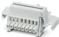
Connecteurs sur profilé, coloris: gris clair, intensité nominale: 6 A, 4 A (contacts parallèles) (Contacts série), tension de référence (III/2): 32 V, nombre de pôles: 8, pas: 2,54 mm, montage: Montage sur profilé, verrouillage: sans, type de fixation: sans, type de conditionnement: emballé dans un carton, Article avec contacts dorés, connecteur de bus pour le raccordement de boîtiers électroniques, 6 contacts parallèles/2 contacts série
